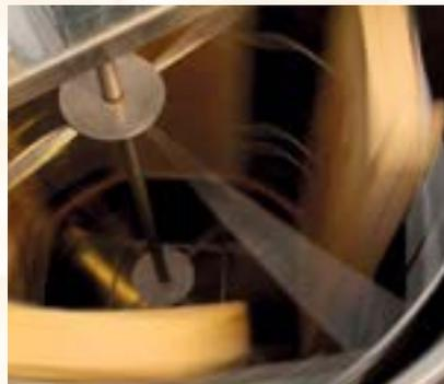
Une fois les alvéoles ouvertes, il faudra enlever le miel des cadres. C'est là qu'intervient la seconde machine : l'extracteur. C'est une cuve dans laquelle les cadres sont installés et grâce à la force centrifuge le miel va s'extraire contre les parois.
